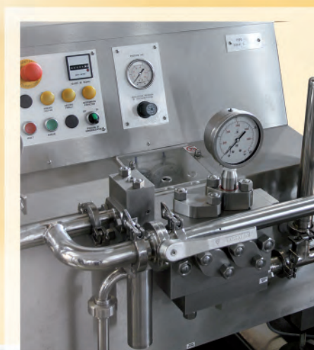
IT Dettaglio della testata di omogeneizzazione
